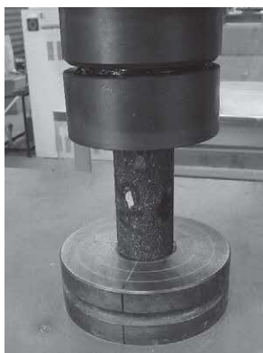
写真-16. 圧縮試験体のセットと加圧装置による载荷の様子
