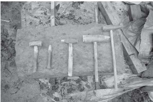
写真62. 壁石加工の使用道具
