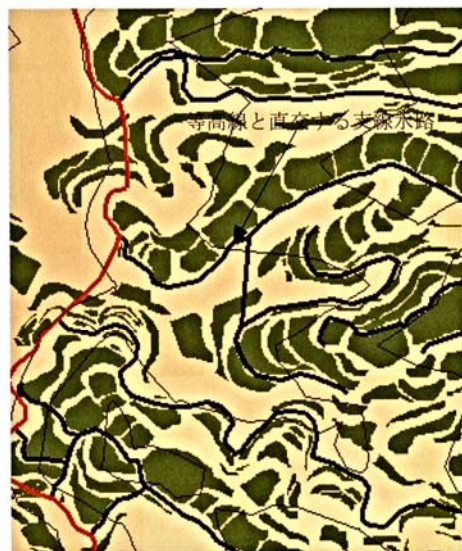
図(Fig)17 等高線と垂直な支線水路
