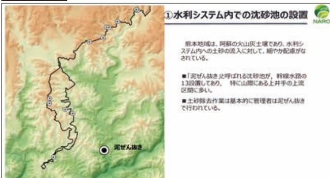
この図に示すグレーの凡例が、通潤用水に設置された「泥ぜん抜き」です。現代では、頭首工の直下流に沈砂池が設置されます。通潤用水では、水路区間の13か所と数多くの「泥ぜん抜き」が設置されています。その設置場所は、水路の湾曲部に
