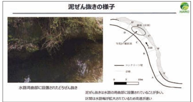
「泥ぜん抜き」で流速を測ったデータを見て下さい。右の表の青く塗った部分がコンクリート区間の流速、黄色で塗った部分が「泥ぜん抜き」の区間の流速です。流速とは、流れる水の速さのことです。特に「泥ぜん抜き」の区間で流速が遅いことがわかります。水の流れが遅いと土砂がそれだけ沈降しやすくなります。流速を遅くすることで、土砂の沈降を促進して、土砂を溜めようとしています。
