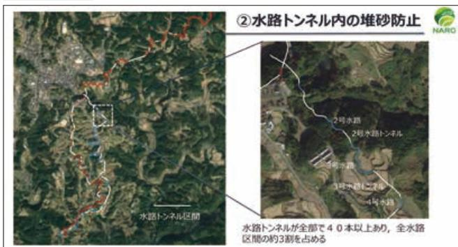
水路トンネルの流速を測ってみますと、「泥ぜん抜き」とは逆に、水路トンネルの区間では流速が速くなっています。水路トンネル区間では水路断面を小さくして開水路区間より流速を速くしています。このことにより、水路トンネル内では土砂が溜まりにくくなっています。
