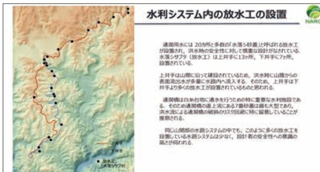
上井手は山際に沿って建設されているため、洪水時はどうしても雨水が入りやすくなります。上井手の流入水を除去するために、「水落シサプタ（砂蓋）」と言われる水利施設が多数、作られています。今の農業土木では、放土工と呼ばれています。通潤用水では、特に上井手に多数の「水落シサプタ」が建設されています。最も大きいサプタは通潤橋の直上流にあります。通潤橋という重要な水利施設を洪水から守りたいという表れでしょう。
