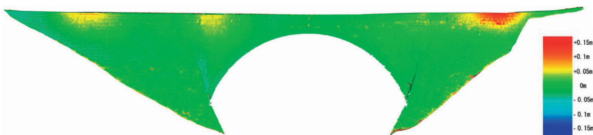
図5-1-13 通潤橋の壁石の孕み出しの状況（上流側）
