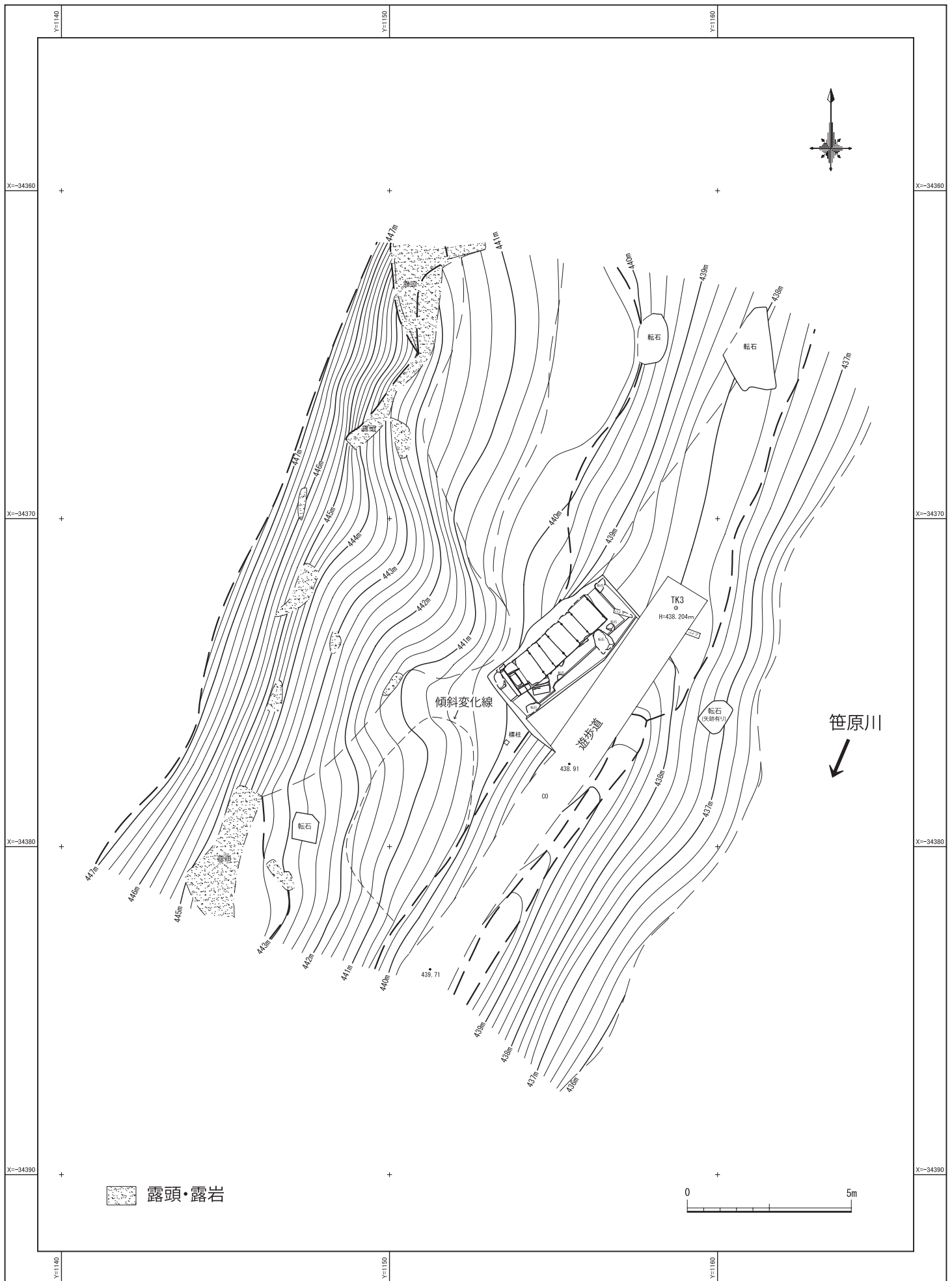
図7-1-8 御試吹上樋（通水石管6点）平面図（S=1/150）
