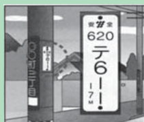
電柱の管理番号
