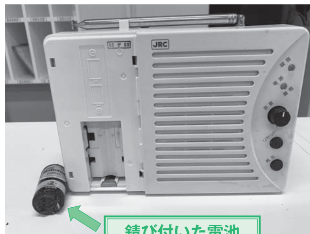
錆び付いた電池
