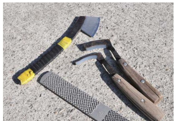
削蹄師が使う道具。2種類の鎌形蹄刀(右)と鉈(左)、 仕上げ用のヤスリ(手前)。削蹄はケガがつきもので、 信宏さんの手には複数の傷跡がありました。
