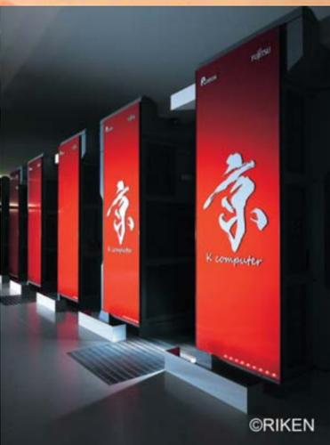
←スーパーコンピュータ「京」。文部科学省による「京速計算機システム」開発計画に応じて、独立行政法人理化学研究所と富士通(株)が共同開発。培ってきたその技術力を結集した、世界最高の性能を持つ超大规模並列スーパーコンピュータ。スーパーコンピュータの性能ランキングであるTOP500で、2011年6月、11月と2期連続して世界一の性能を持つシステムとして認定された。
