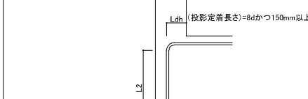
図6. 4 仕口せいが小さい場合の鉄筋の折曲げ定着
