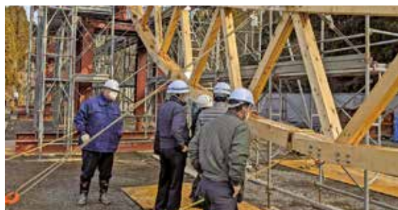
▲議会では、体育館アリーナの天井に使用する木トラスの耐荷試験の見学をしました。町有林のヒノキを使用。
