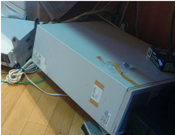
山都町 図書館 写真位置：⑨ 2F受付フロント サーバ NEC EXPRESS 5 8 0 0 【被害】 床置き式の機器が転倒 ・強打し、起動しない 【復旧】 機器購入
