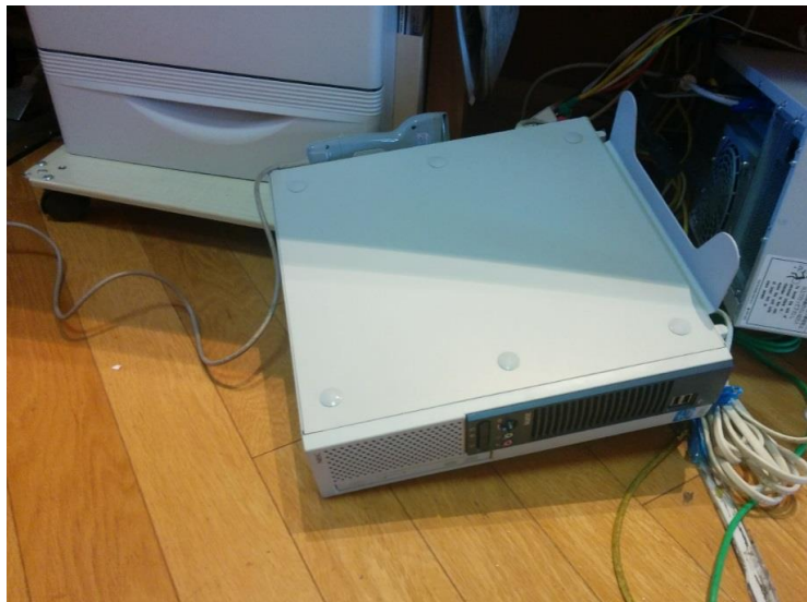
山都町 図書館 写真位置：⑨ 2F受付フロント 図書管理端末 NEC Meie J MB 【被害】 床置き式の機器が転倒 ・強打し、起動しない 【復旧】 機器購入
